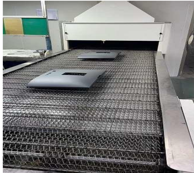
UV線噴漆線 UV line spray paint line
